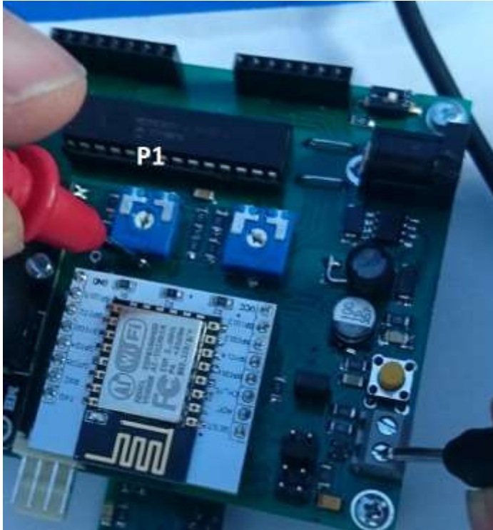
scala 2000mV Fig.5. Determinare experimentală a valorii V_{REF\_ADC}
