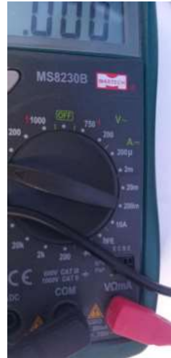
scala 2000mV Fig.5. Determinare experimentală a valorii V_{REF\_ADC}
