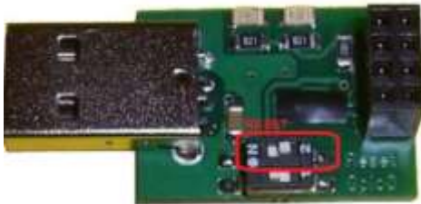
Figura 7. Convertorul USB-UART. Ambele comutatoare sunt OFF
